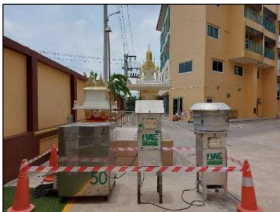
รูปที่ 3-3 การตรวจวัดคุณภาพอากาศภายในพื้นที่โครงการ
