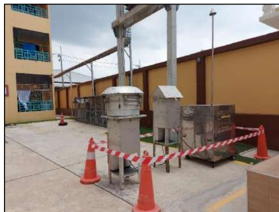
รูปที่ 3-3 การตรวจวัดคุณภาพอากาศภายในพื้นที่โครงการ
